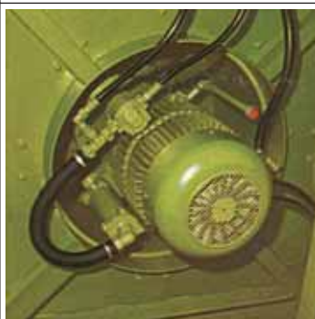
Obrázek vlevo: Pohon míchačky elektromotorem přes kardanovu hřídel a převodovku (T 750 až T 1670)
