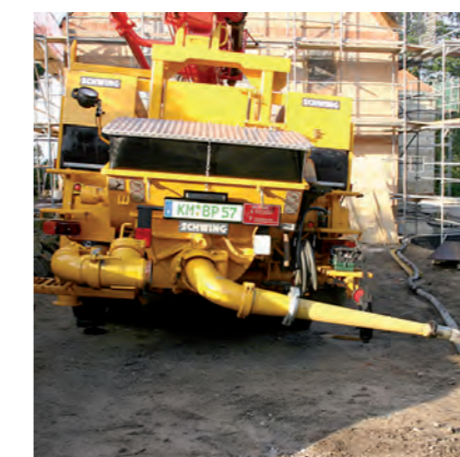
Der optional erhältliche drehbare Abgang gestattet dem Maschinisten, auf jeder Seite der Maschine Förder-schläuche anzuschließen.
