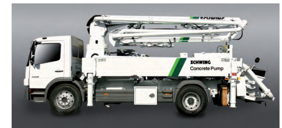
Ob auf einem 15 oder 18 t Fahrgestell; Die geringe Fahrzeuglänge und die niedrige Ausfalthöhe machen diese Maschine zur perfekten City-Pumpe.
