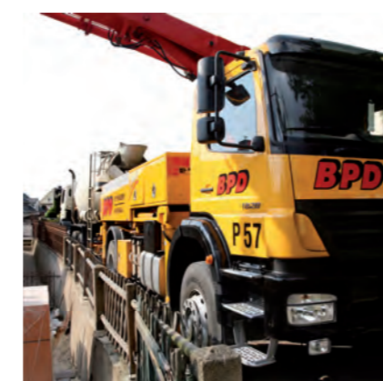
Bei einer Breite von 2,45 m und einer Höhe von 3,52 m kommt diese Maschine in jede noch so kleine Ecke.
