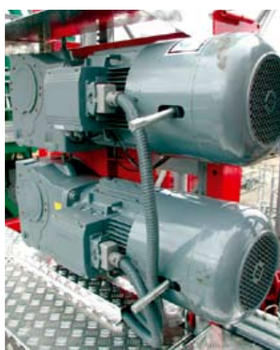
• Приводное устройство на крыше кабины
