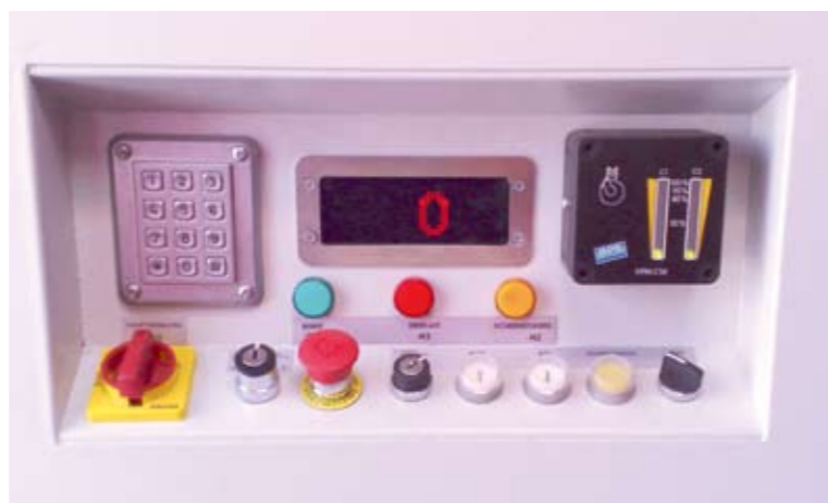
• Панель управления с распознавателем перегрузки и индикацией неисправностей
