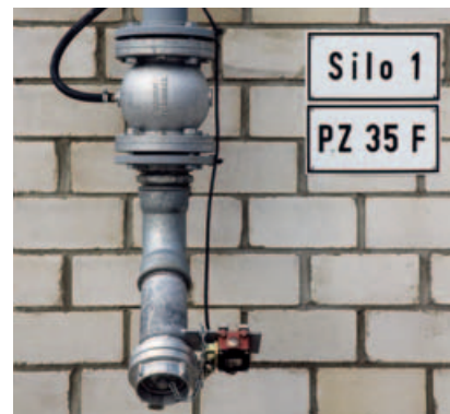
Перепускное устройство для связующего соответствует требованиям правил техники безопасности. Отжимной клапан в комплексе с опциональным реле давления препятствует передуванию бункеров со связующим.
