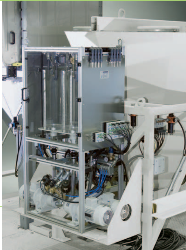
Там, где раньше для дозирования добавок применялись расходомеры или волюметрические дозирующие устройства, фирма «Stetter» сегодня монтирует весы с полностью автоматической дополнительной промывкой. Размер и количество ориентируются на потребности.
