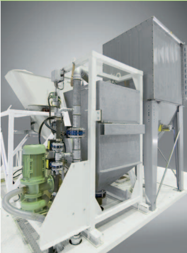
Логическое развитие, связанное с установками рециклизации: Горячеоцинкованный весовой резервуар для воды для взвешивания чистой воды и воды, содержащей шлам с остатками бетона. Весы можно комбинировать с нагнетательным насосом для шламовой воды. Подача воды в смеситель осуществляется через спиральные форсунки.
