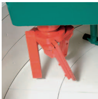
Завихритель обеспечивает наибольшую однородность бетона и наилучшее растворение цементного связующего.
