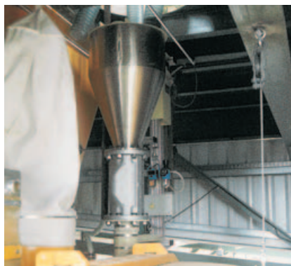
Весы для порошка для подачи гранулированных красителей или микросилика.
