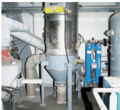
Для того чтобы максимально сократить количество пыли на платформе смесительной установки, по желанию можно установить вытяжное устройство принудительного действия.
