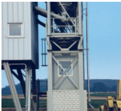
Размещенный на высоте контейнер с системой управления МС и сильноточной частью обеспечивает свободный обзор разгрузочной воронки смесителя.
