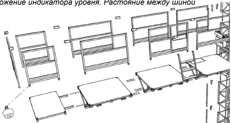
Рисунок 4.25. Монтаж боковых помостов.
