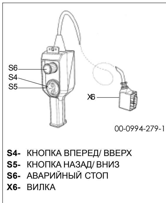
Рисунок 4.32. Кассета управления E3 (привод горизонтальный/ вертикальный)
