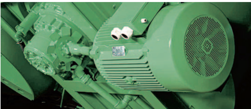
Привод с планетарным редуктором и прифланцованным гидравлическим насосом.
