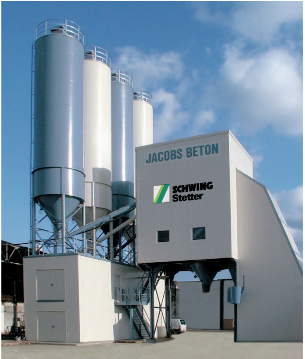
HN 3,0 с двухвалковым смесителем, производительность по жесткому бетону 120 м 3 / час.
