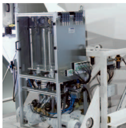
Весы для присадок для химических добавок.
