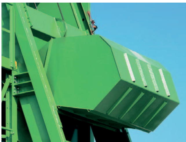
Большое по размеру загрузочное устройство благодаря своей оптимальной форме обеспечивает полное опорожнение.
