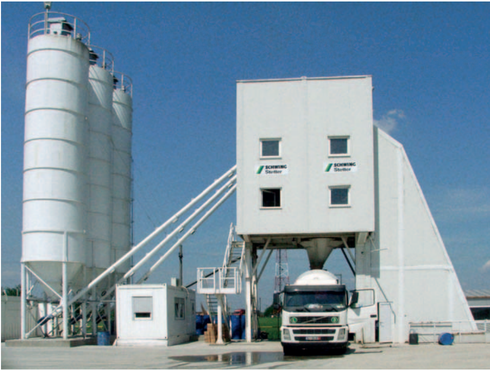
HN 2,25 с тарельчатым смесителем, производительность по жесткому бетону 100 м 3 /час.
