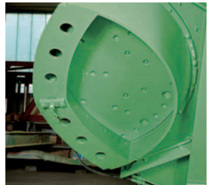
Широкий по размеру затвор смесителя с приводимой в действие с помощью гидравлики заслонкой для быстрого опорожнения.
