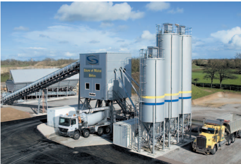
HN 1,5 с тарельчатым смесителем, производительность по жесткому бетону 78 м 3 /час.
