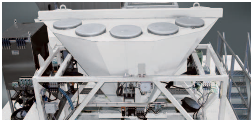
Весы для связующего для взвешивания до семи сортов цементных наполнителей.
