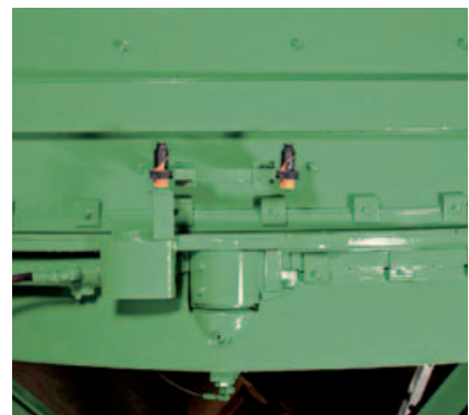
Нарушение электроснабжения? Мы подумали и об этом и интегрировали гидравлическое устройство, чтобы в экстренной ситуации затвор смесителя можно было привести в действие вручную.
