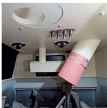
Распылительная насадка для чистки внутреннего пространства смесителя.
