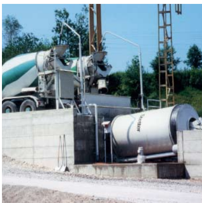
Заглубленное конструктивное исполнение с загрузкой на уровне земли.
