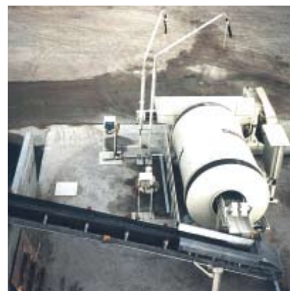
Конструктивное исполнение с ленточным конвейером для транспортировки твердых веществ.
