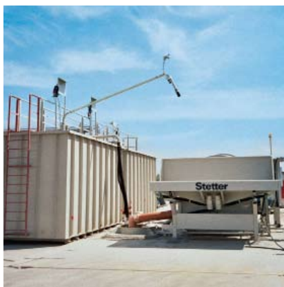
Напольное исполнение с двойным контейнером для промежуточного накопления шламовой воды, рекомендуется при каменистых грунтах или при применении в качестве мобильной установки.
