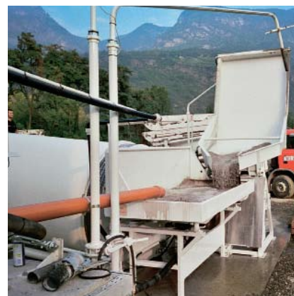
Приводимое в действие с помощью гидравлики загрузочное устройство для забора остатков из бетононасосов, объем 1100 литров.
