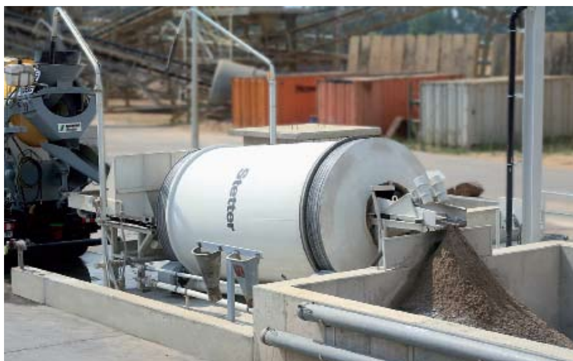
Стандартное конструктивное исполнение с опциональным загрузочным устройством для бетононасосов.
