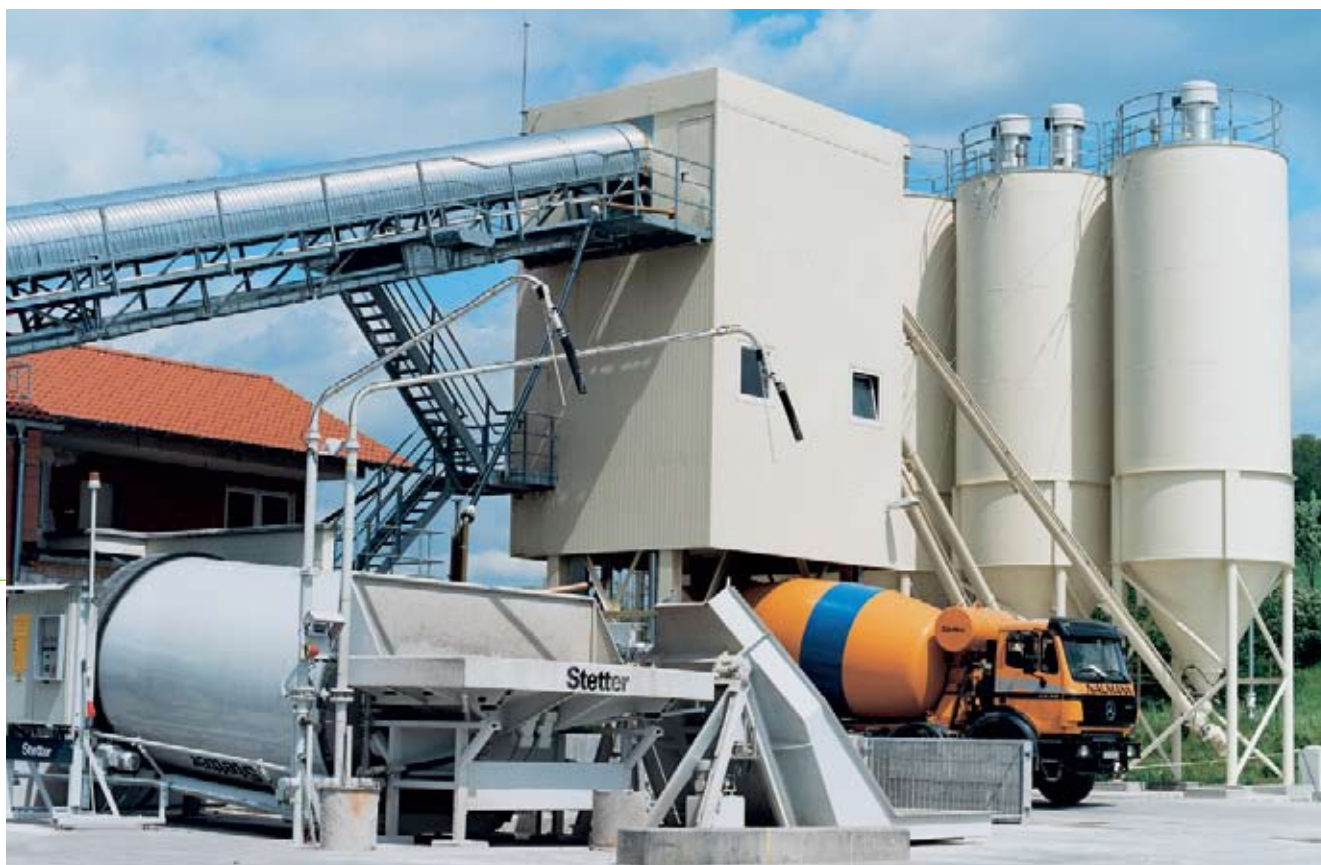
RA 20 с прямоугольной загрузочной воронкой шириной 3,2 м, два водяных журавля и опциональное загрузочное устройство
