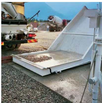
Приводимое в действие с помощью гидравлики загрузочное устройство для забора остатков из бетононасосов, объем 1100 литров.
