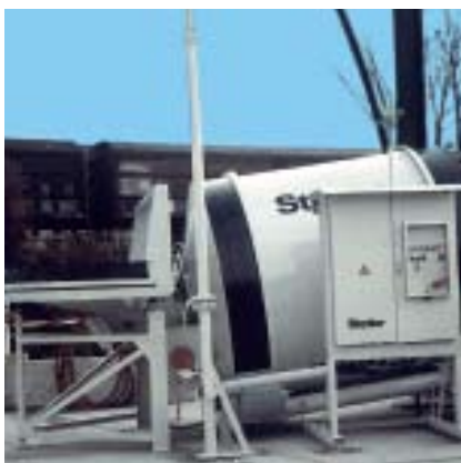
В качестве альтернативы для RA 12/20 может поставляться полукруглая загрузочная воронка шириной 2,5 м.
